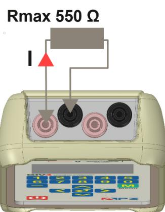
Choisir le type de boucle puis valider. GIV4 montre un écran de la connexion type \*\*\* à réaliser et invite à valider \*\* pour afficher l'écran de simulation. Celui-ci indique alors que GIV4 est en mode simulation de boucle x-20mA. Dans cette fonction, GIV4 génère un courant de 0 à 24 mA en fournissant l'alimentation de boucle. En cas de courant mesuré par l'autocontrôle différent de la valeur souhaitée, l'affichage fait clignoter le message *Sortance*.
