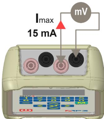
Dans cette fonction, GIV4 permet les mesures de tensions mono-polières de -0.5 V à +31 V. En cas de tension inverse ou supérieure aux valeurs admissibles, l'affichage de la mesure clignote à -0.50 ou +31.00 suivant le cas. GIV4 affiche également en plus la valeur en %, les valeurs crêtes haute et basse. La sélection de l'une d'elles et un appui sur la touche " $< -$ ", permet d'en positionner la valeur égale à celle égale de la mesure en cours.
