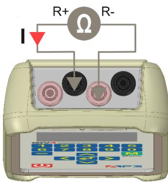
Choisir le type de sonde puis valider. GIV4 montre un écran de la connexion type \*\*\* à réaliser et invite à valider \*\* pour afficher l'écran de simulation. Celui-ci indique alors que GIV4 est en mode simulation de capteur ainsi que le type de thermosonde sélectionnée. La valeur simulée se règle en °C ou °F au moyen des touches numériques et de navigation.
