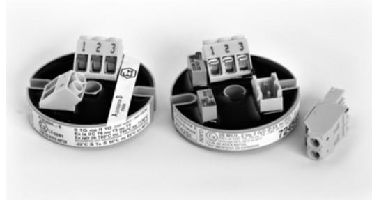
Les transmetteurs pour atmosphères explosives XT42SI et XT43SIH font appel à une technologie qui permet de réduire de façon importante le coût et le volume tout en apportant une amélioration des performances : grande dynamique de réglage et linéarisation des sondes et capteurs. Ces transmetteurs 2 fils auto alimentés convertissent température, niveau, potentiomètre ou résistance en signal 4-20mA.
