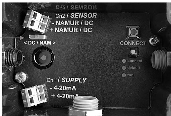
Le mini interrupteur sera positionné sur « NAM » si le capteur utilisé est un détecteur NAMUR ou sur « DC » s'il s'agit de contact libre de potentiel.
