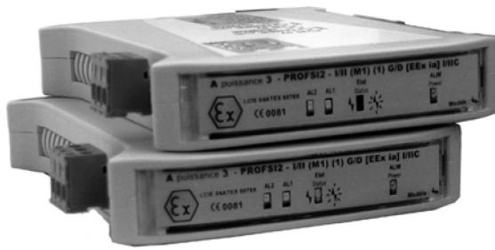
Le thermostat numérique PROFSI2-APT...2A permet le raccordement d'une sonde température PT100 installée en zone explosive - zone 0, 1, 2 ou 20, 21, 22- et le déclenchement de 2 seuils indépendants. Les sorties se font sur 2 relais repos/travail, les états des relais sont accessibles par programmation.
