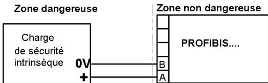
**Raccordement de la fonction communication**
