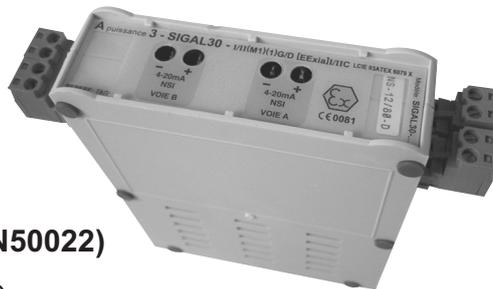
Les isolations galvaniques auto-alimentées de sécurité intrinsèque SIGAL30 permettent le transfert de boucle de courant soit de la zone non dangereuse vers la zone dangereuse (modèles NS), soit l'inverse (modèle SN). Le choix pourra se faire sur différents modèles afin d'optimiser la boucle, tant en caractéristiques métrologiques qu'en paramètres de sécurité.
