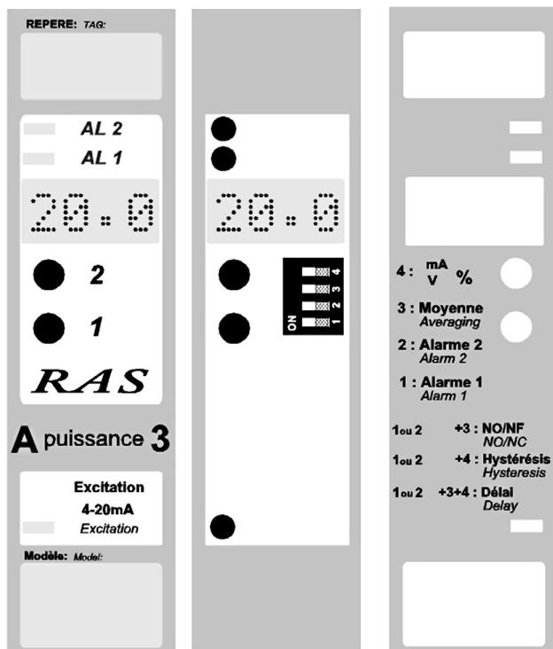
Pour programmer l'appareil, enlever le filtre de façade pour accéder aux interrupteurs de programmation.
