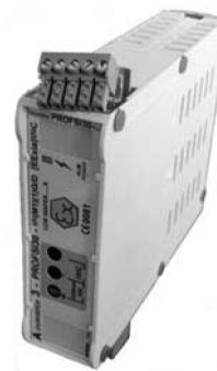
Les convertisseurs de mesure PROF30-APT ou ANIV...-ISH permettent le raccordement direct en entrée une sonde de température PT100 (modèle APT) ou un potentiomètre (modèle ANIV) et donnent une sortie 4-20mA isolée galvaniquement compatible HART®.
